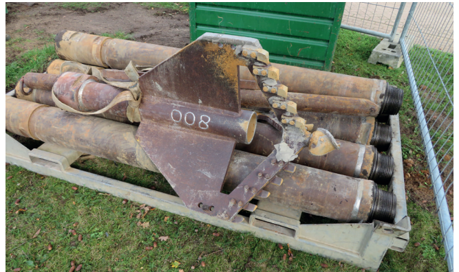
Afb. 2: Boorkop voor de bronboringen (ca. 80 cm diameter).
